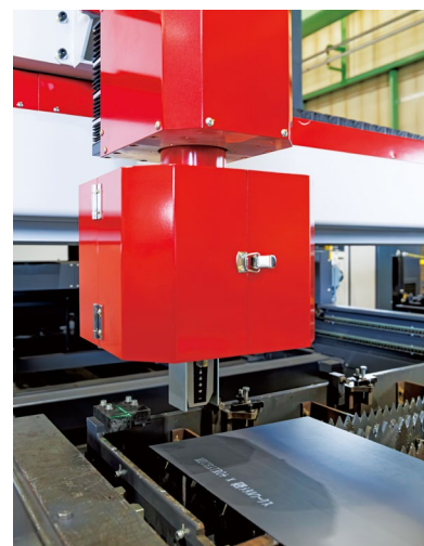
2024年8月に後付けで導入したコータキ精機製のマーキング装置。
