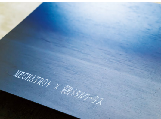
後付けしたマーキング装置で鋼材に白い文字を自動で印字できる。
