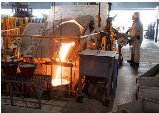
鑄造を担当する本社工場。左は注湯工程、右は冷却工程。本社工場で鑄造した部品の2割ほどは吉良工場に搬送し、精密加工を施してから出荷する。
