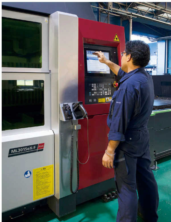
2017年3月に導入した出力6kWのファイバレーザー加工機「ML3015eX-F60」。二次元加工はこの加工機を優先的に用いている。
