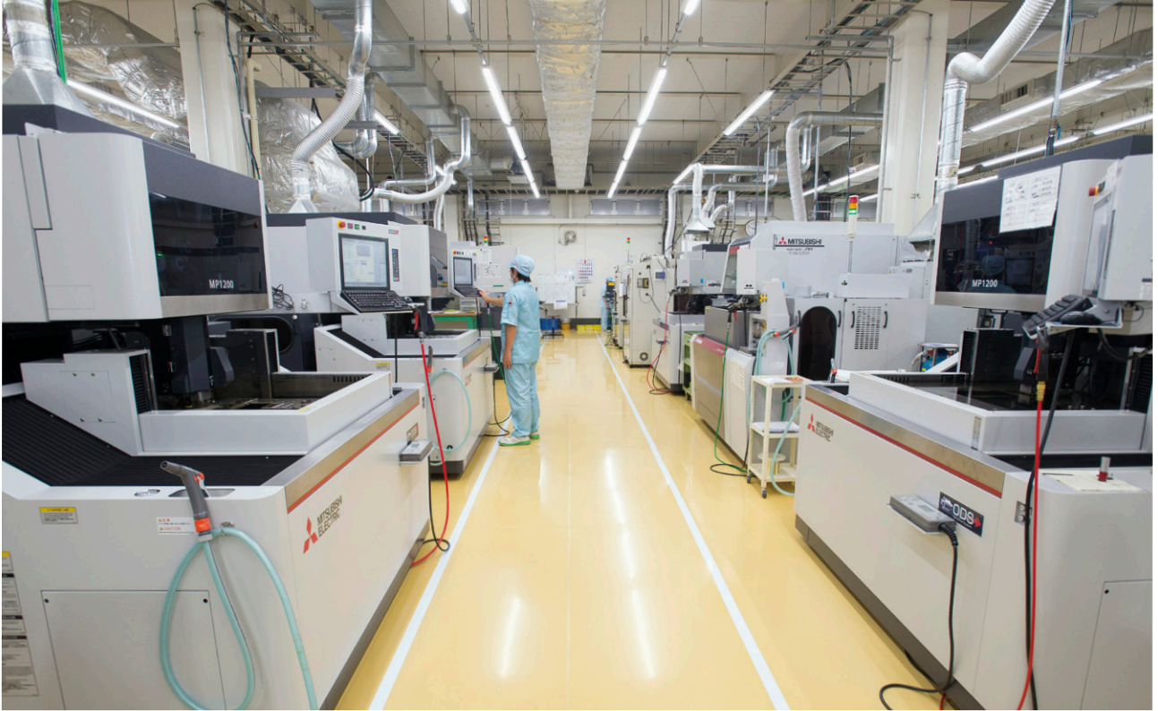
金型を製造する金型技術センターのワイヤ放電加工機ライン。高い加工精度を維持するため室温を±0.5℃に保ち、加工水にはミネラル分をほとんど含まない雨水をろ過して使用する。
