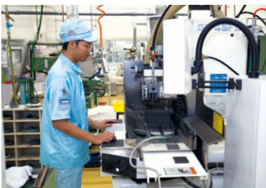
研磨加工機。高精度を実現するため、機械も砥石もメーカーと共同で独自開発した。
