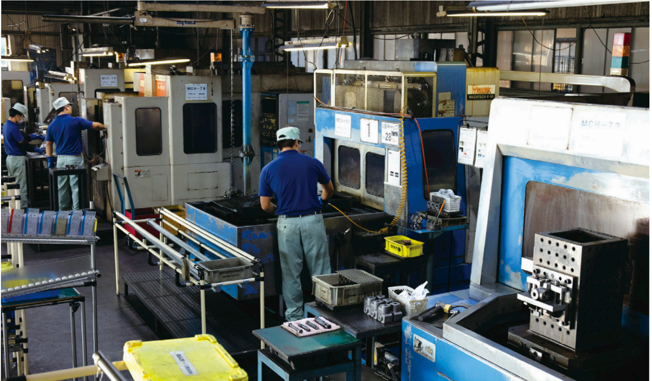
旋盤やマシニングセンタがずらりと並ぶ中日本鑄工の吉良工場。80台ほどの工作機械が稼働している。うち30台ほどに三菱電機のカNCが搭載されている。
