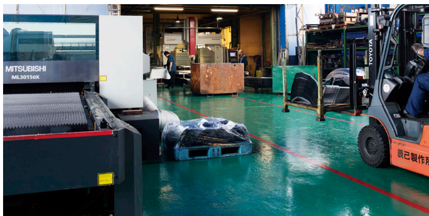
辰己製作所の工場。手前の建屋で二次元レーザー加工、奥の建屋では三次元レーザー加工を行う。
