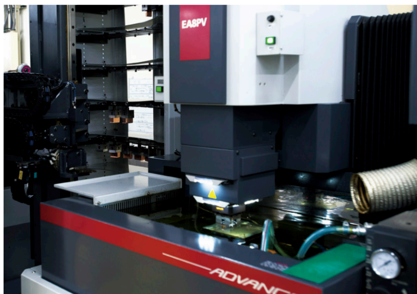
ATC(電極自動交換装置)とワークチェンジャを装備した形彫放電加工機「EASPV ADVANCE」。放電加工機は三菱電機の協力を得て、ユウワ仕様のものを導入している。
