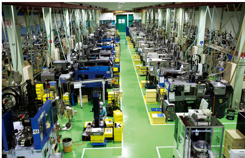
88台の射出成型機がずらりと並ぶ第1工場。精密電子部品用成型品を製造するため、工場内はクラス10万のクリーンルームに保っている。
