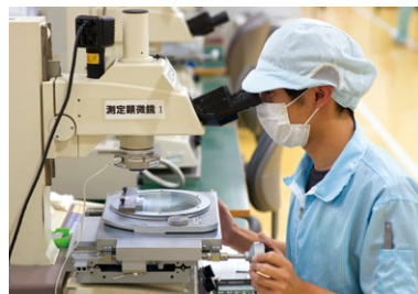
金型の検査工程。完成した金型の加工精度は±1μm以内と高い。
