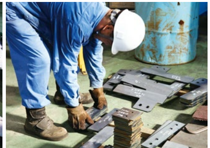
鉄の成分によって加工精度が変わる場合もある鋼材。同社でも希望する精度がでるまで三菱電機と綿密な調整を重ねた。
