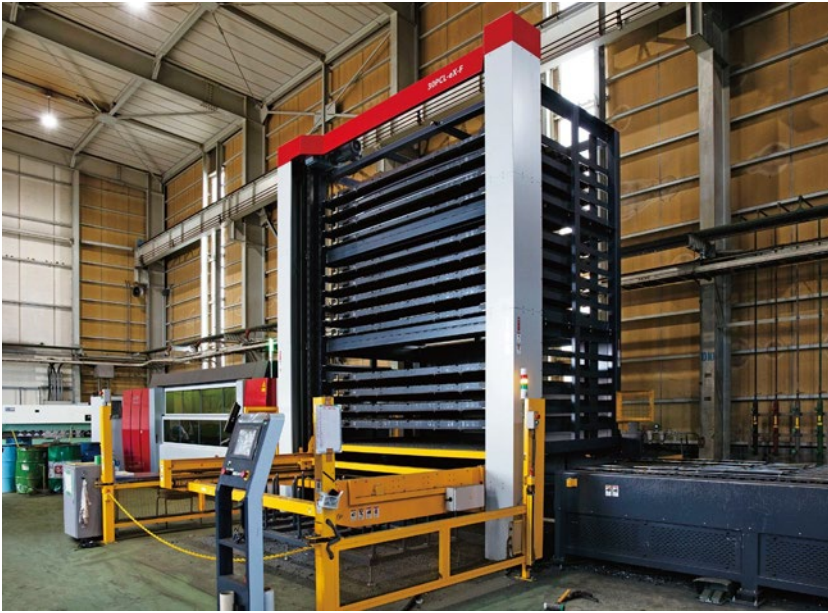
ファイバレーザ加工機には15段のパレットチェンジャがセットされている。これにより昼夜にかかる効率よい稼働が可能となった。
