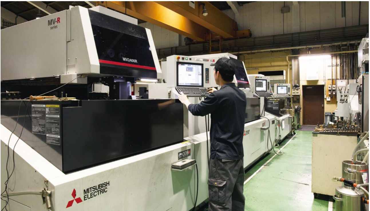
ここ5年間でみても、2015年導入のMV2400RとMV4800。2018年にはMX600。今年に入ってからMV2400S D-CUBESとMX2400を導入するなど、本社工場では計8台の最新鋭のワイヤ放電加工機が稼働している(写真はMV2400R)。
