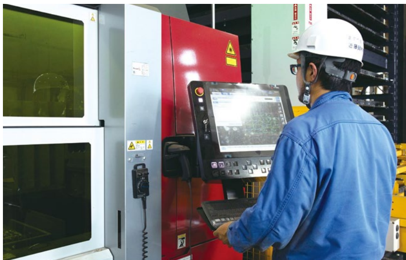
6kWファイバレーザ加工機ML3015eX-F60を導入したことで加工速度も上がり、生産性が向上したという。
