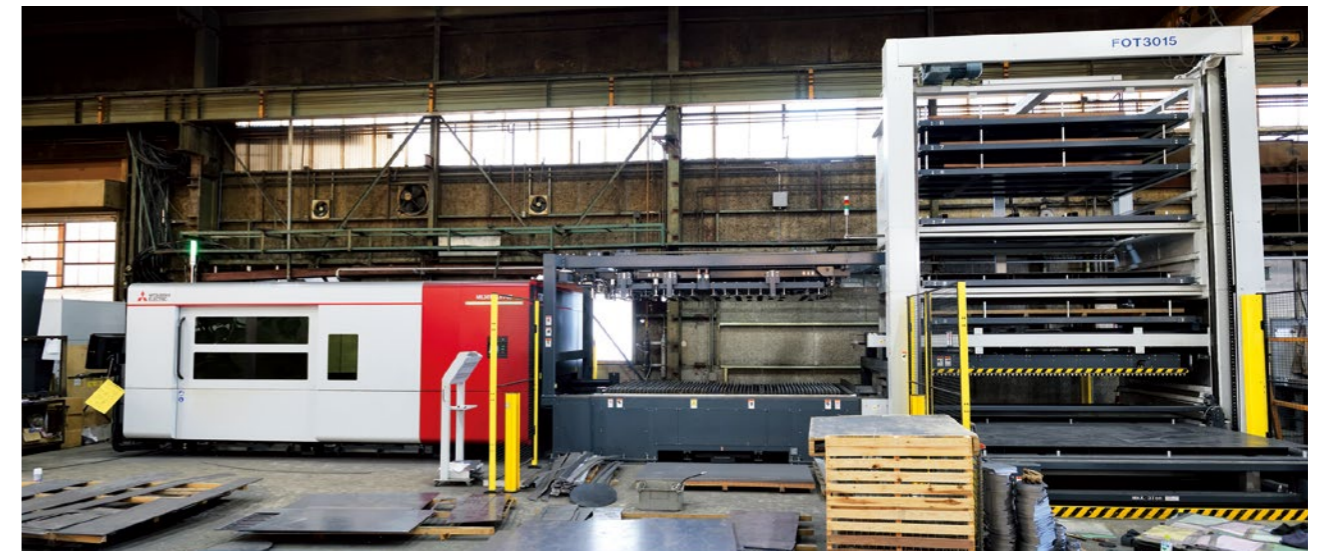
出力6kWの二次元ファイバレーザ加工機「ML3015GX-F60」（左）により厚板の高速切断が可能となったほか、従来悩まされた加工中のバーニングはゼロになり、AIアシスト機能で切り損じもなくなった。自動シートチェンジシステム「FOT3015」（右）は素材4段・製品4段の8段構成を採用する。
