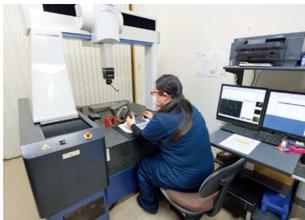
福島第一工場では2004年から三次元測定器を導入している。出荷前の部品形状をスティック先端のボールでポイントし、PCプログラムに読み込んで測定する。
