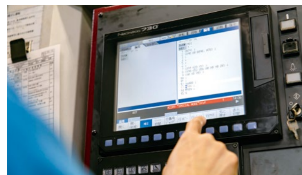
1ブロックに対してMコードを複数挿入できる三菱電機製のCNC数値制御装置
