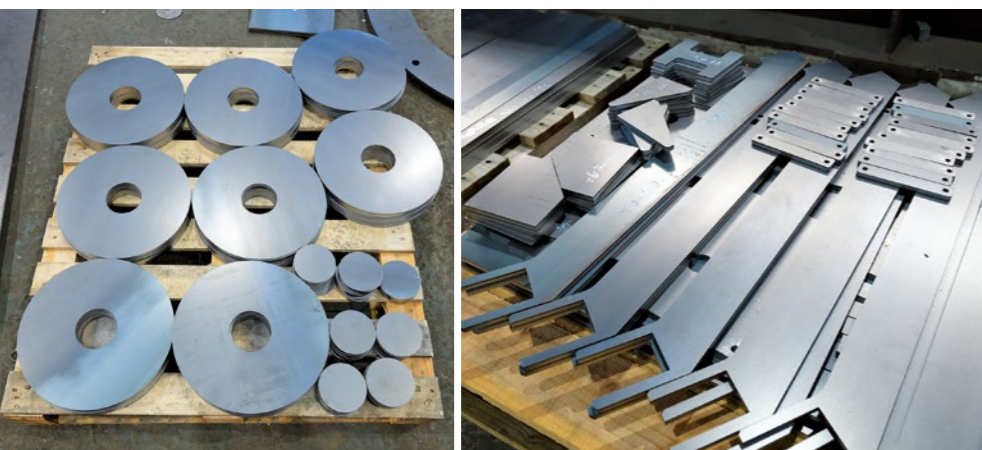
切断と穴開け加工を終えた製品。「ML3015GX-F60」によって、16/19/22mm等の厚板に直径4~5mm程度の小穴を高品位で開けられるようになり、顧客からも高い評価を得ている。
