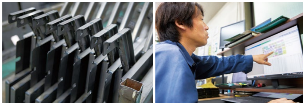
レーザー加工機などで加工した部品(左)。鋼板から最適な部品取りを行うためのネスティングCADのデータと、自動仕分けシステム「ASTES4」で仕分けするためのソートCADのデータを作成・確認する(右)。
