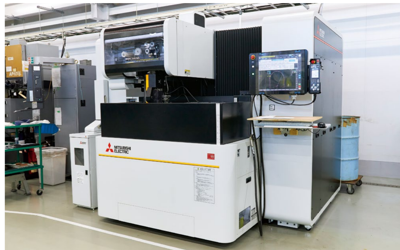
2022～2023年で2台導入されているワイヤ放電加工機「MX2400」。難度の高い超硬合金の加工を行う上で、「MX2400」の高い精度と再現性から、金型に対する難しい要望にも応えられるようになったという。
