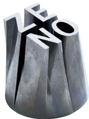
ワイヤ加工機で制作した自社の「ZENO」をモチーフにしたオブジェクト。細部にまでその技術が表れている。
