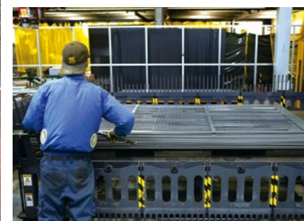
レーザ加工機で部材を切り出した後の鋼板も所定の位置に自動で積み上げられる。
