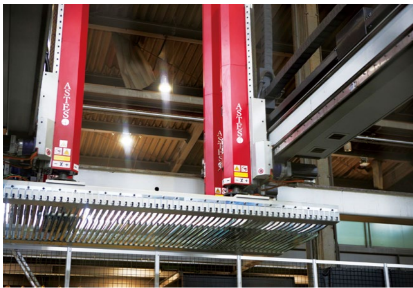
自動仕分けシステム「ASTES4」。赤い柱状の部分がアーム、その下に接続しているのがパレットチェンジャーで、ここに加工前の鋼板、加工後の部品などが載る。アームの先端は作業内容に応じて切り替えられる。
