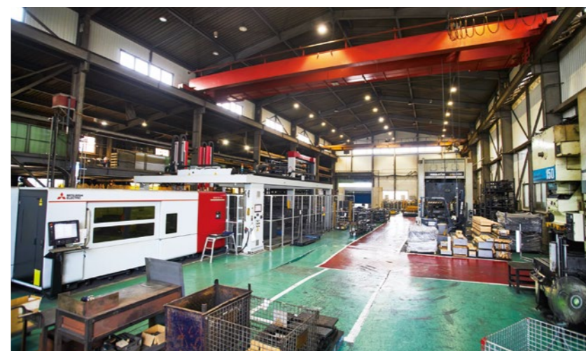
三興プレス工場の内部。左手前がファイバレーザー加工機、その先に自動仕分けシステム「ASTES4」、9段棚が繋がっている。さらに工場の奥で三菱電機製レーザー加工機2台が稼働している。
