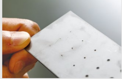
直径0.2～1.0mmのレーザ細孔加工。バリやダレが少ないシャープエッジな加工を実現
