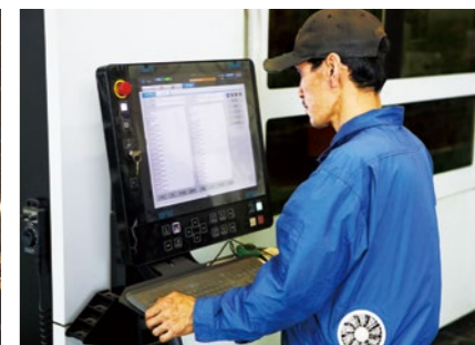
レーザ加工機横の制御パネルでは進捗状況の確認や、プログラムの修正などを行える。
