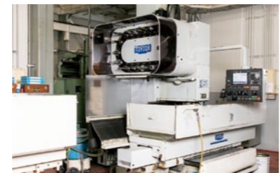
NCリプレースを実施した立形マシンニングセンタ
