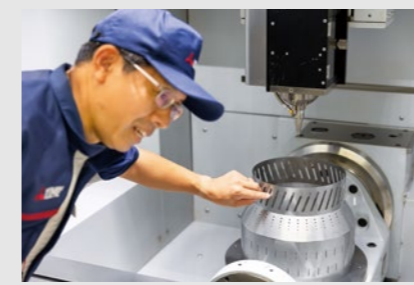
ヘッド側直線3軸とテーブル側回転2軸の同時5軸制御で高速化と高精度化を両立
