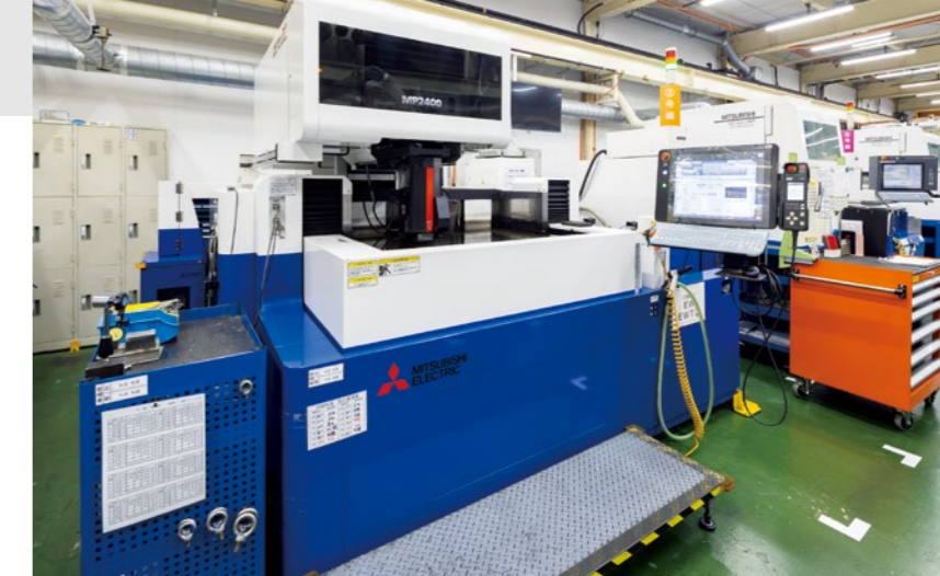
中型高精度品の加工に使用されている三菱電機のワイヤ放電加工機MP2400(上、右とも)。エクセディのユニフォームに合わせ、カラーをブルーと白にカスタマイズ。
