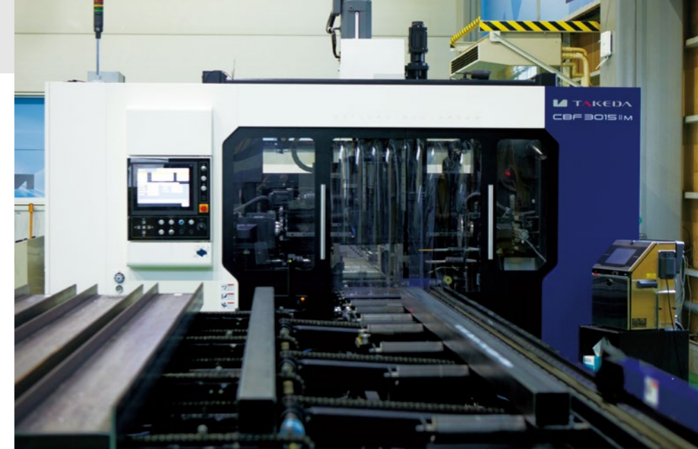
形鋼加工機 CBF-3015II-M (奥) を自動搬入装置の端から見たところ。加工機の左右と上に合計3軸の穴開け機がある。左側のモニターが15インチ画面の三菱電機製CNC装置。マルチタッチ操作が可能だ。
