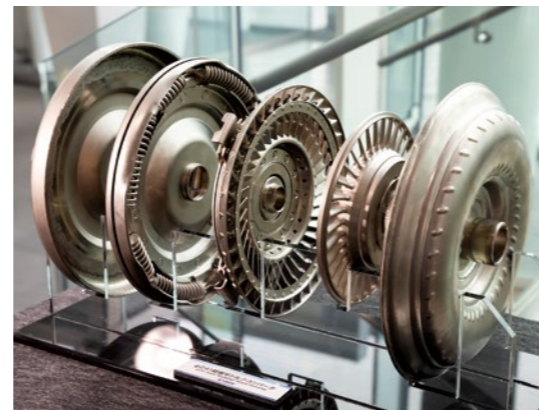
省スペース・軽量化のために設計された超扁平トルクコンバータの分解モデル。
