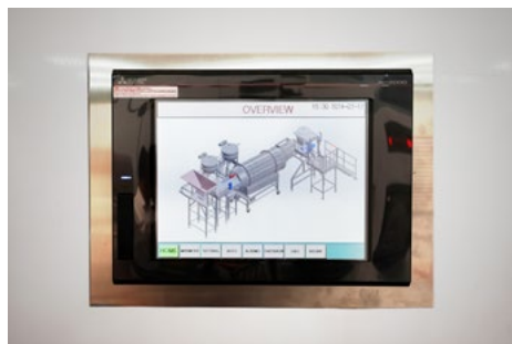
SV Agri社はシーズニングラインや焙煎ラインのFA機器に、三菱電機のPLC、サーボ、HMIを採用しています。
