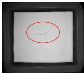
AIを用いた自動検査システム
