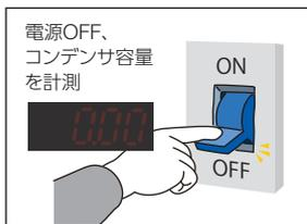
電源をOFFします。インバータ電源OFF時に直流電圧を印加してコンデンサ容量を測定します。
