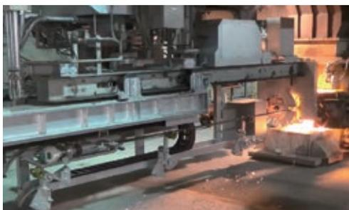
ごみ処理施設の一方式である熔融炉では、長いパイプを炉内に挿入し、溶け残った熔融物に酸素を吹きつけ排出する洗浄作業が行われます。洗浄作業は遠隔操作で行われますが、リアルハプティクス®を適用することで、オペレータが酸素洗浄装置を通して炉内の状態を力触覚として把握できるようになり、酸素洗浄の作業性が向上しました。さらに、オペレータの動きやノウハウなどの暗黙知を定量的なデータとして「見える化」して形式知とすることが可能となり、経験の浅いオペレータがこのデータを手本にして操作を行うことで技術の伝承も行えるようになりました。
