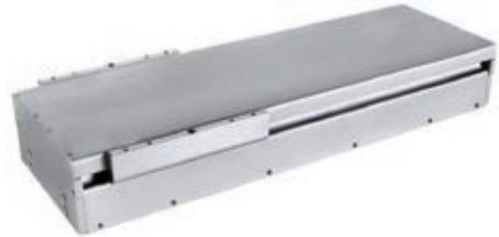
DGLシリーズはリニアモータリニア駆動の測位システムを採用しています。ダブルガイドレール、リニアモータ、エンコーダによるフィードバックシステムとアルミ製筐体によって構成されたコンパクトかつ高性能なモジュールです。DGLのリニアモータはアクリビス システムズが特許を取得したコアレス/AUMシリーズもしくはコアタイプ/AJMシリーズのリニアモータを使用しています。コアレス/AUMによりコギングトルクフリーが実現され、安定精密速度制御が実現できます。コアタイプ/AJMは、ポイントツーポイントに適した、より高コストパフォーマンスの製品となっています。
